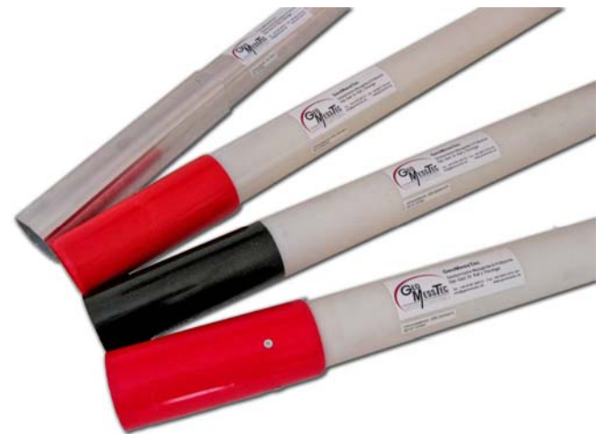
Abb. 3: Beispiele für unterschiedliche Inclinometer-Messrohrtypen, von oben: Aluminiumrohr \varnothing 76 mm, ABS-Rohr \varnothing 71 mm mit 3,5 mm Materialstärke, ABS-Rohr \varnothing 70 mm mit 5 mm Materialstärke und durchmesserkonstanter Muffe, ABS-Rohr mit 5 mm Materialstärke und Schnellkupplungs-System
